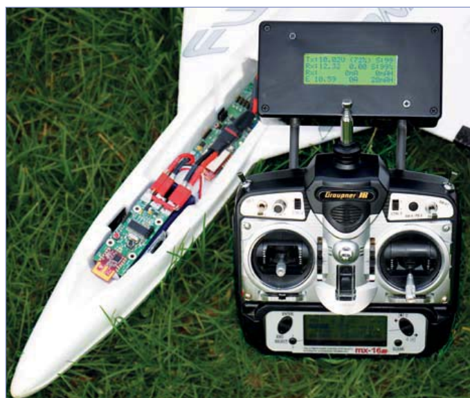
Bild 7. Dieses Flugmodell ist voll ausgestattet: Achtkanal-2,4-GHz-Empfänger und Fernmesssystem für die Akku-Parameter.
